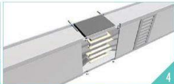
4) Arka ve ön ek kapaklarının vida ve somunlarını takınız ve sıkınız. 4) Assemble screws and nuts of joint covers and tighten. براغي ووصلات التجميع لأغطية التوصيل والإحكام
